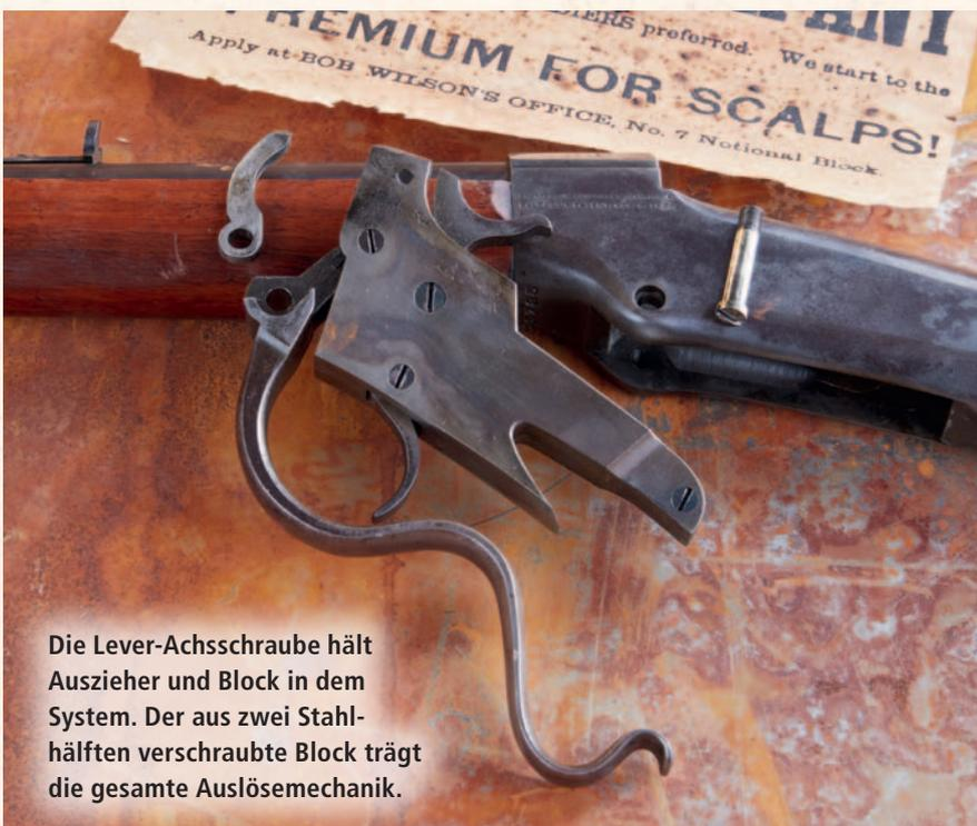
Die Lever-Achsschraube hält Auszieher und Block in dem System. Der aus zwei Stahlhälften verschraubte Block trägt die gesamte Auslösemechanik.
