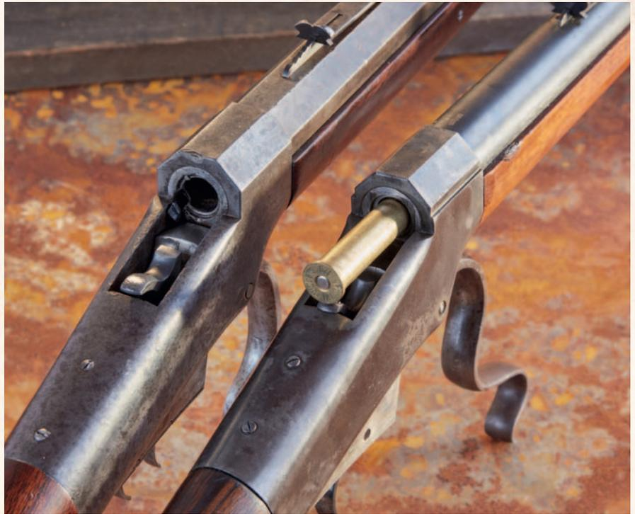
Senkt man per Unterhebel den Block samt allen mechanischen Elementen, tritt der Auszieher in Aktion und das Patronenlager ist zugänglich.
