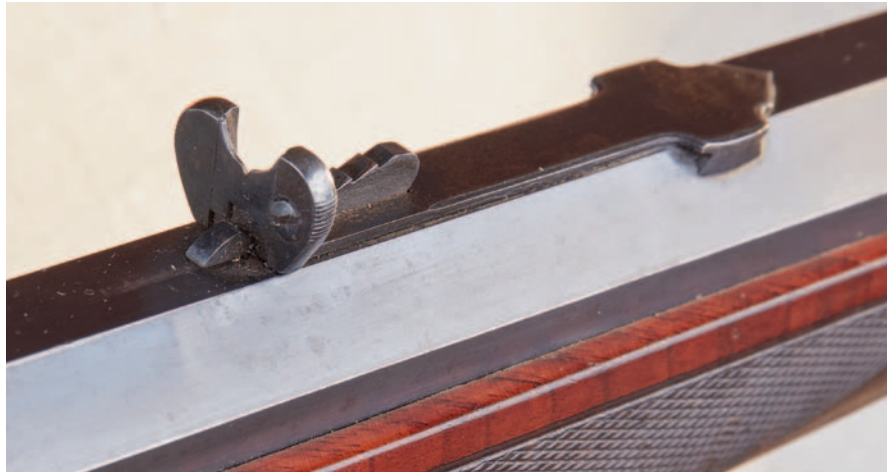
Hinten auf dem Lauf der M 1885 eine Federstahl-Buckhorn-Kimme, die sich über einen Treppenschieber in der Höhe verstellen lässt.
