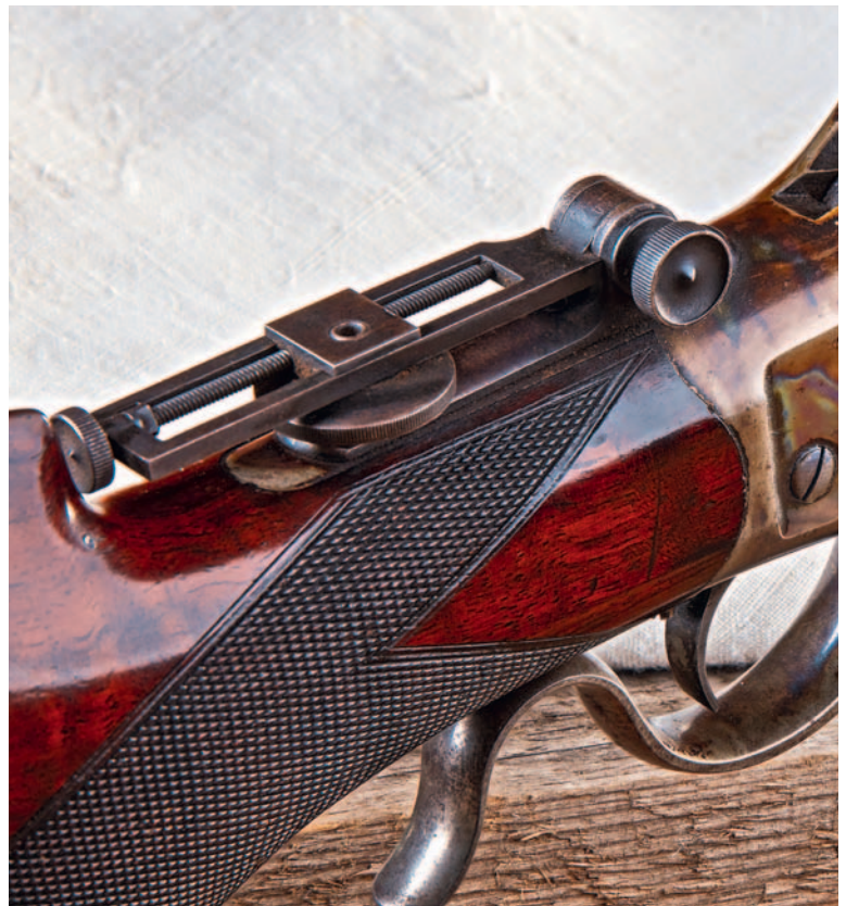
Auf dem Kolbenhals ein höhenverstellbares Spindeldiopter des Typs Winchester Mid Range Tang Sight, das sich umklappen lässt.
