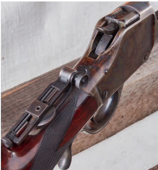
Der zentral positionierte Hahn lässt sich entweder manuell spannen oder durch die Auf- und Abwärtsbewegung des beweglichen Levers (= Abzugsbügel-Unterhebel) aufziehen.
