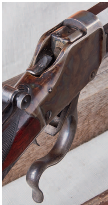
Der zentral positionierte Hahn lässt sich entweder manuell spannen oder durch die Auf- und Abwärtsbewegung des beweglichen Levers (= Abzugsbügel-Unterhebel) aufziehen.
